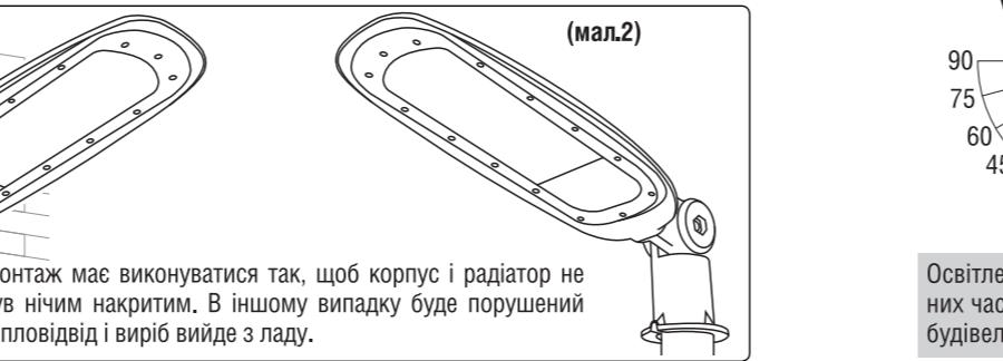
Рекомендована висота монтажу – 6 м. Максимальна ефективність освітлення досягається за умов правильного виконаного монтажу світлодіодного вуличного ліхтаря.
